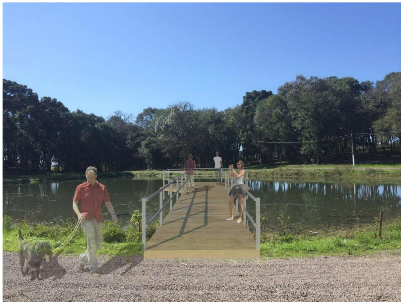
**7. Passarela Trilha:** Sua função é de elevar o trecho da trilha peatonal onde o pavimento é alagadiço. A passarela seguirá o eixo de araucárias recentemente plantadas no parque, criando assim um passeio contemplativo e sombreado. Sua estrutura é em pau roliço autoclavado e piso com pranchas de madeira igualmente tratadas;
